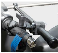
Befestigung des Haltearmes mit Kreuzklammer am Lenker
