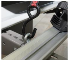
Zwei Zurrösen am Heckträger
