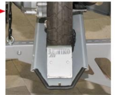
Unterlegkeil befestigt auf Motorradschiene
