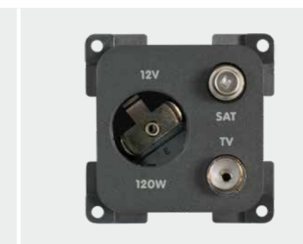
MP12ATVS / ... PRESA 12V AUTO + TV+ SAT (TV 9,5 75ohm - SAT F 75ohm)
