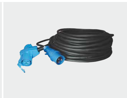
R425/S 212957** Cavo flessibile H07RN-F 3 x 2,5mm 2 , L=25m con spina maschio e presa femmina CEE 230V 90°, derivazione presa Schuko Conforme normativa CEI per caravan
